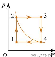
30. Идеальный одноатомный газ, количество вещества которого  $\nu = 1,00$  моль, совершил замкнутый цикл, точки 1 и 3 которого лежат на прямой, проходящей через начало координат. Участки 1–2 и 3–4 этого цикла являются изохорами, а участки 2–3 и 4–1 — изобарами (см. рис.). Работа, совершенная силами давления газа за цикл,  $A = 831$  Дж. Если в точке 3 температура газа  $T_3 = 1225$  К, то чему в точке 1 равна температура  $T_1$ ? Ответ приведите в Кельвинах.
